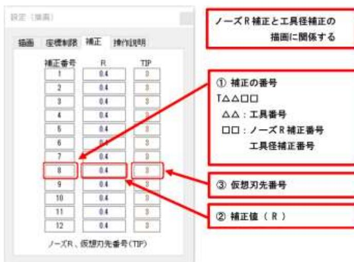
図 1-23 NCxT for FANUC LATHE の補正 (ノーズR、工具径)
