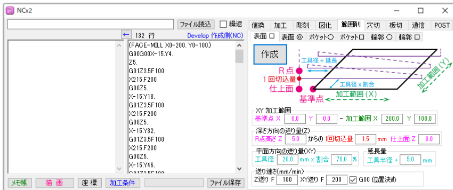
「表面加工 □」：加工範囲を一方向にフライス加工
